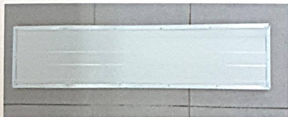
Mẫu thử trước khi thử lan truyền lửa
