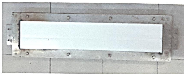
Mẫu thử sau khi thử lan truyền lửa
